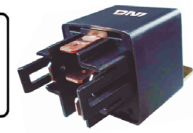
DNI8165 RELAY AUXILIAR DOBLE 5 TERMINALES CON SOPORTE 12V 15/15A PARA: HYUNDAI, KIA
