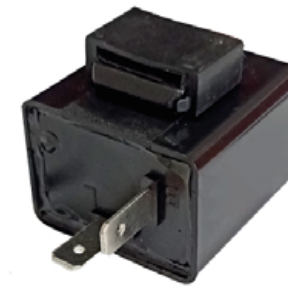
DNI1101 FLASHER 2 TERMINALES, CON CIERRE DE GOMA POTENCIA MÁXIMA 24W USO UNIVERSAL
