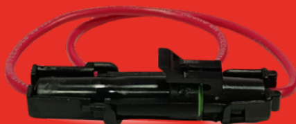
CIP1007 SWA1C- Conector sensor de oxígeno DAEWOO con cable N° 16 879306-879203
